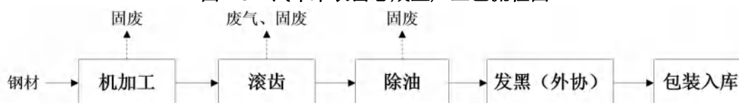
图2-4 汽车涡轮蜗杆生产工艺流程图
