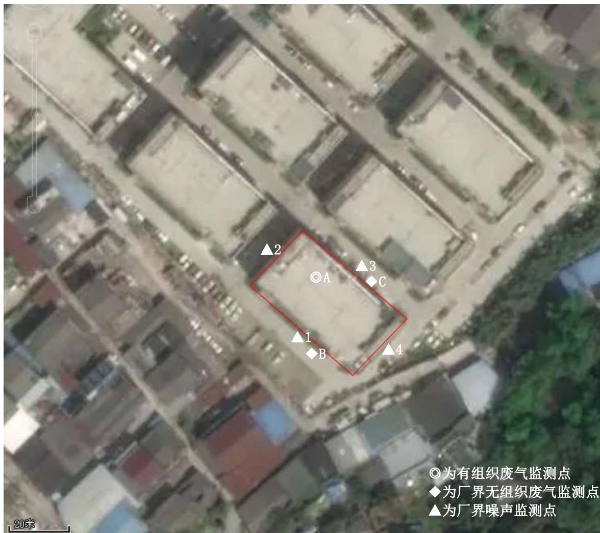
图 3-2 项目平面布置及污染源监测点
